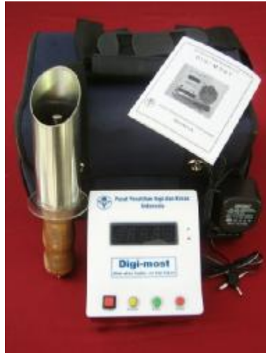
Gambar 7. Alat Pengukur Kadar Air Biji Kakao
