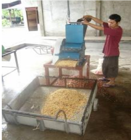
Gambar 1. Mesin Pengupas Biji Kopi ( Pulper ).
