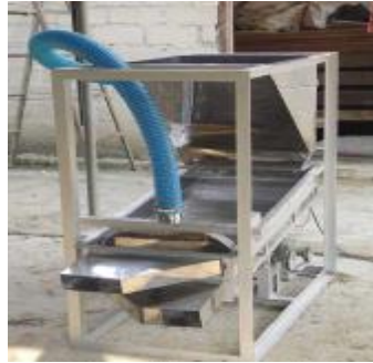
Gambar 8. Alat sortasi lada kering
