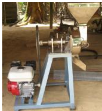
Gambar 11. Alat pengupas kulit buah lada
